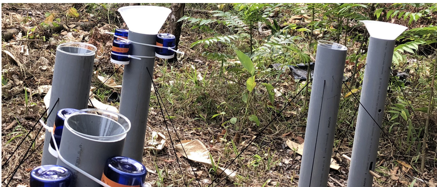
Figura 5. Colectores de agua de lluvia (tubos de PVC) y de aire (frascos azules).
