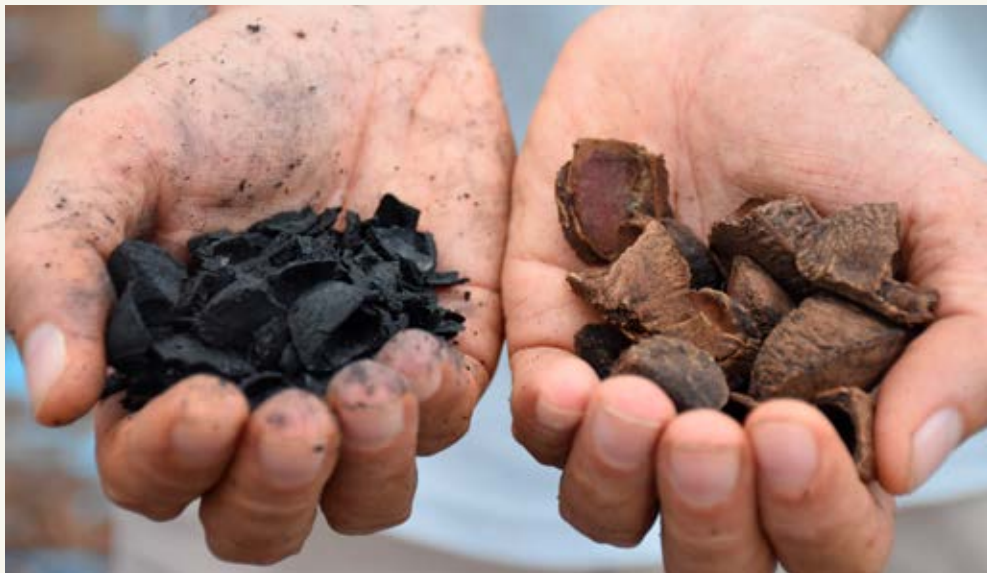
Foto 10: Biocarbon de residuos de cascara de castaña. Fuente: WWF Perú, 2018.
