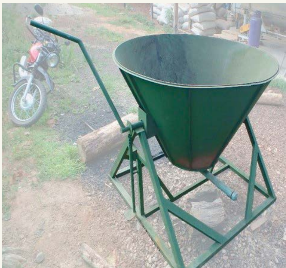
Foto 13: Sistema semi industrial tipo Kon Tiki. Fuente: CINCIA, 2018.
