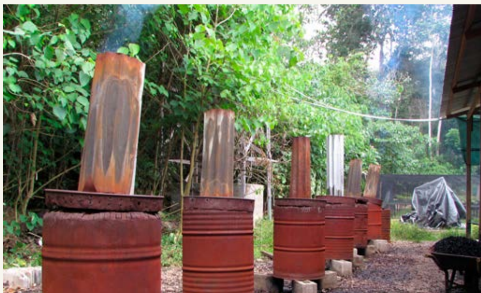
Foto 12: Equipo artesanal, batería de cilindros TLUD (Top-Lit Up-Draft). Fuente: Archivo CINCIA, 2018.
