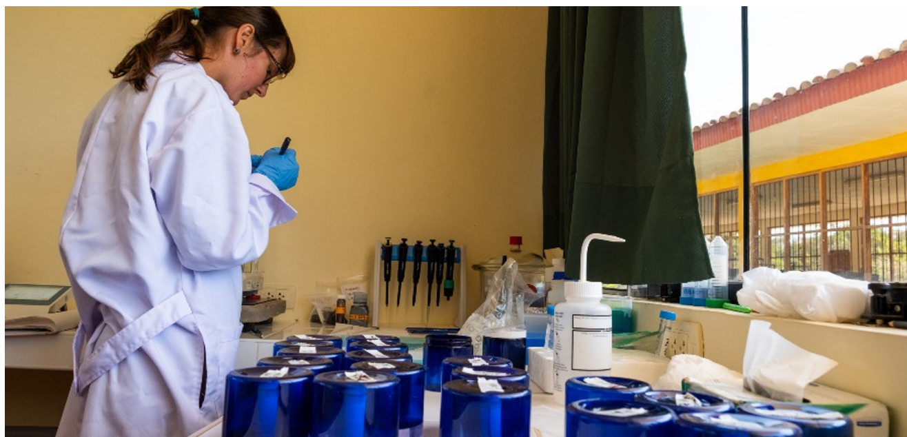
Procesamiento de muestreadores pasivos de aire (PAS) utilizados para evaluar la concentración de mercurio en el aire.
