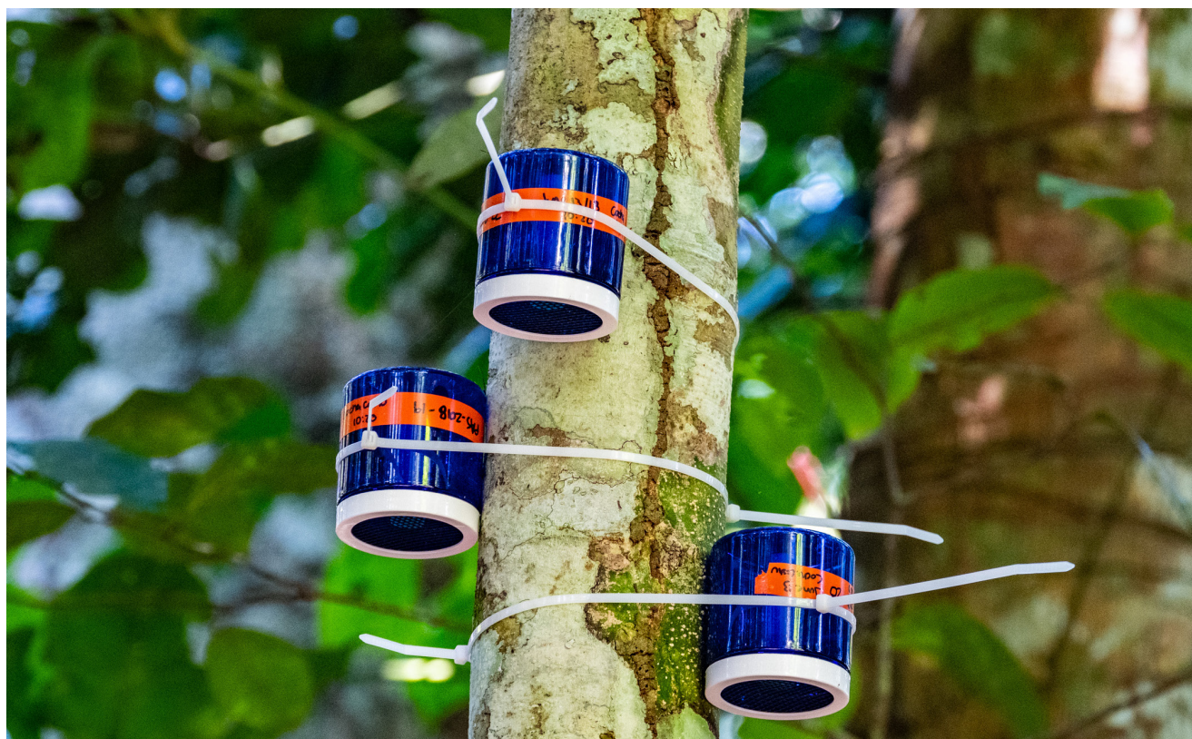
Muestreadores pasivos de aire (PAS) instalados en el Parque Nacional del Manu para medir la concentración de mercurio en el aire.
