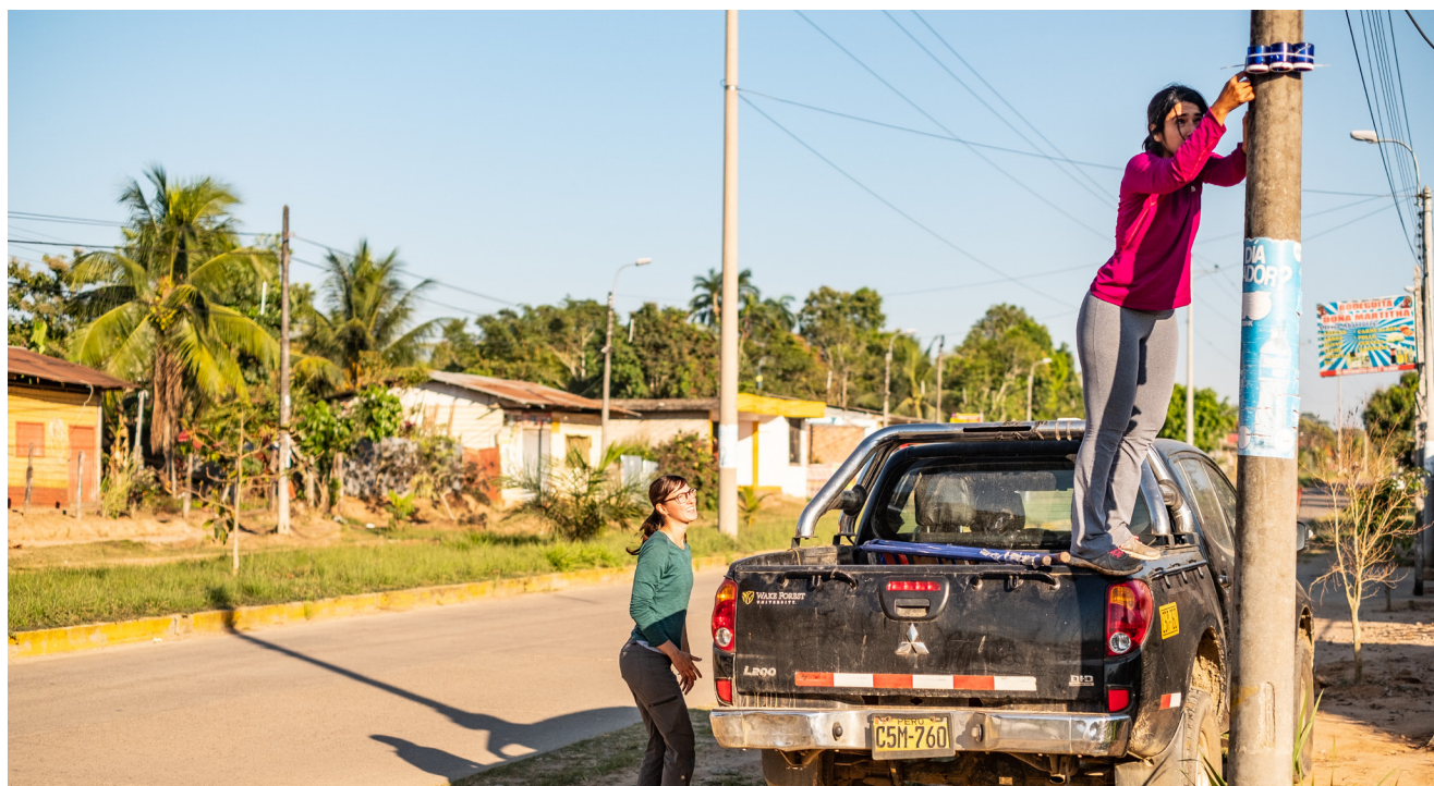
Instalación de muestreadores pasivos de aire para evaluar las concentraciones de mercurio en puntos de monitoreo ubicados a lo largo de la carretera Interoceánica, Madre de Dios.
