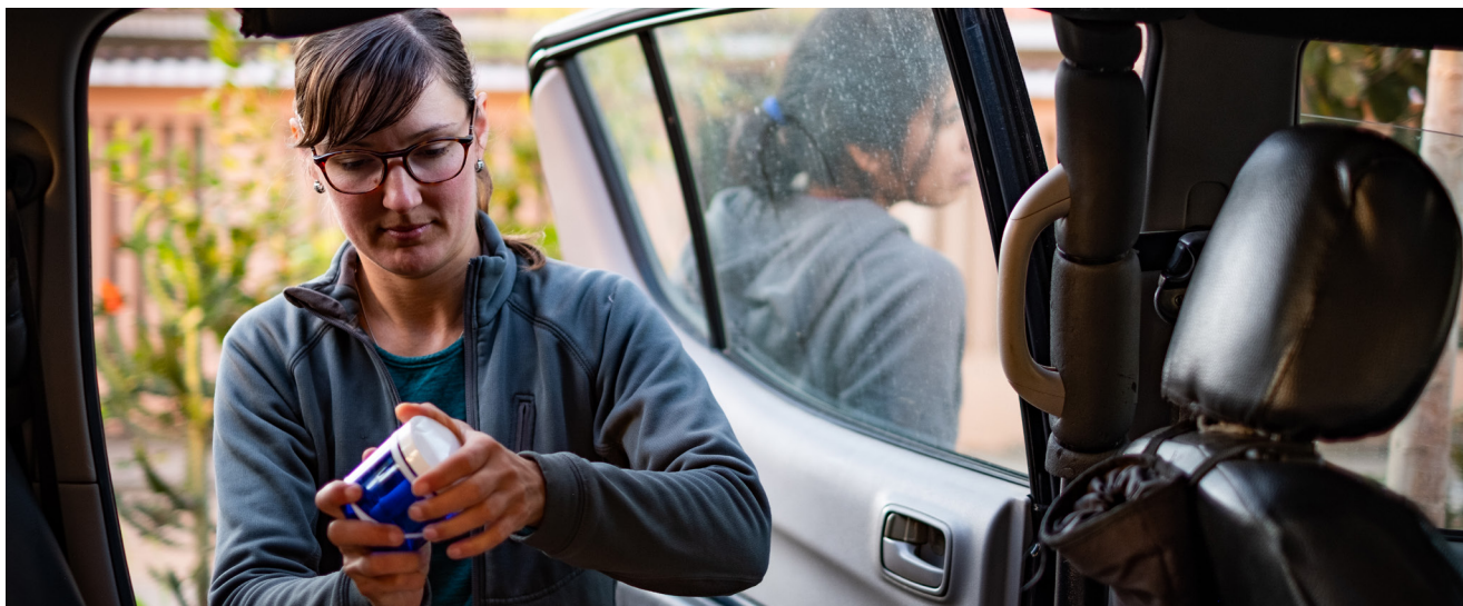
Manipulación de muestreadores pasivos de aire para el monitoreo de mercurio.
