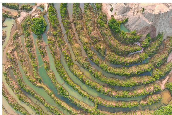
Fig. 3: Las tecnologías de extracción dejan transformaciones físicas distintas en el paisaje. Ortoimágenes de drones ilustran mosaicos de agua, sedimento expuesto y parches de vegetación asociados con bombas de succión, así como superficies más profundamente excavadas y retrabajadas asociadas con maquinaria pesada. Las imágenes son ilustrativas de patrones observados y no representan la extensión total de cada tecnología. Fuente: CINCIA, ortomosaicos de drones.
