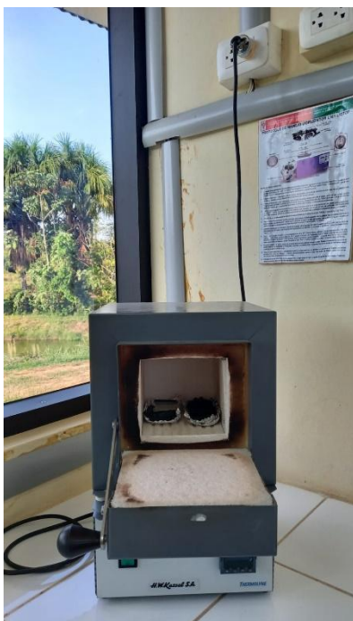
Figura 13. Mufla conectada a tomacorriente con conexión a tierra y con botes de muestras dentro.
