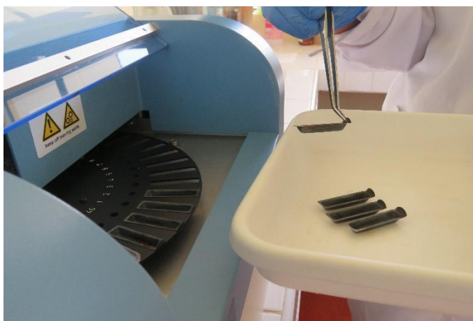
Figura 8. Retiro de los botes o celdas del equipo DMA-80
