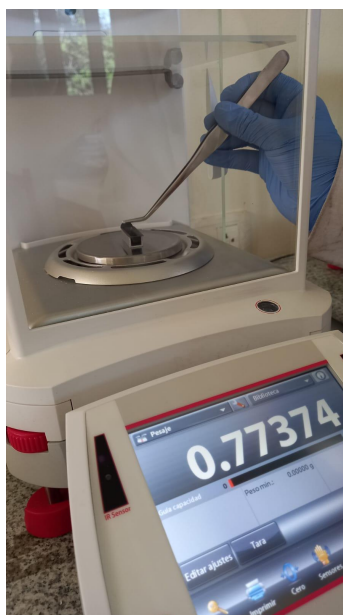
Figura 22. Colocación del soporte para muestras y el bote para muestras dentro de la balanza analítica
