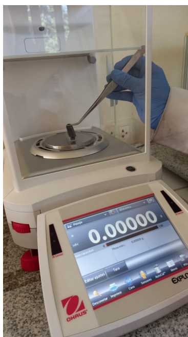
Figura 23. Retiro del bote para muestras para colocar fuera de la balanza el material a pesar
