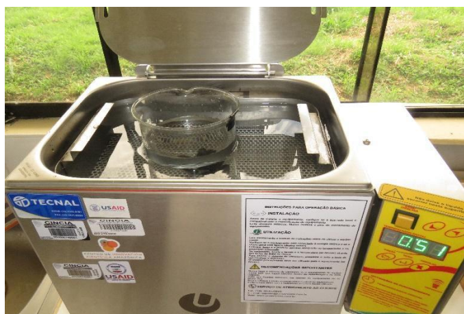
Figura 9. Vaso de precipitados con botes de níquel dentro del baño de ultrasonido.
